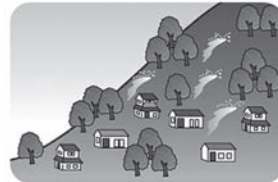
③斜面から水が噴き出す
