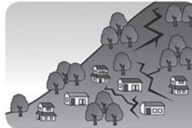
②地割れができる
